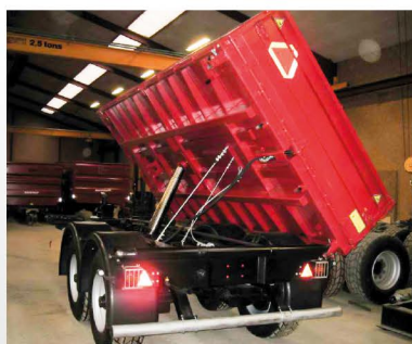
Kardanophængt cylinder, med 6 led. 3-vejstipbeslagene er med lastbildele.
