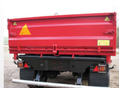
Hydraulisk bagsmæk, drejeligt prodsøje- træk, lovpligtigt LED-lys og klarjort til indregistrering.
