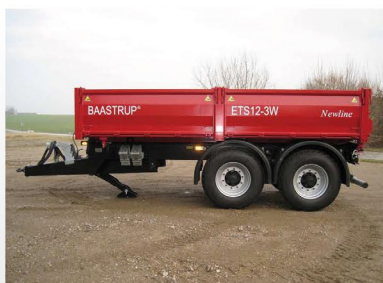
5 mm pladebund med faste hjørnestolper. Siderne er delte på midten og er udført som profilbukkede 4 mm plade.
